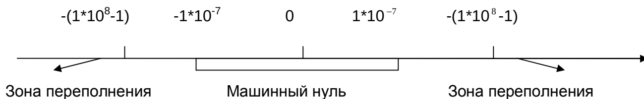
Рис. 5. Множество чисел, представимых в ЭВМ в форме с фиксированной запятой
