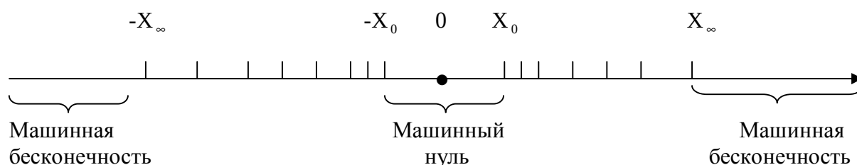
Рис. 3. Расположение чисел на машинной числовой оси
